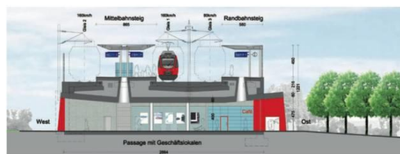
Querschnitt durch den neuen Bahnhofsbereich
